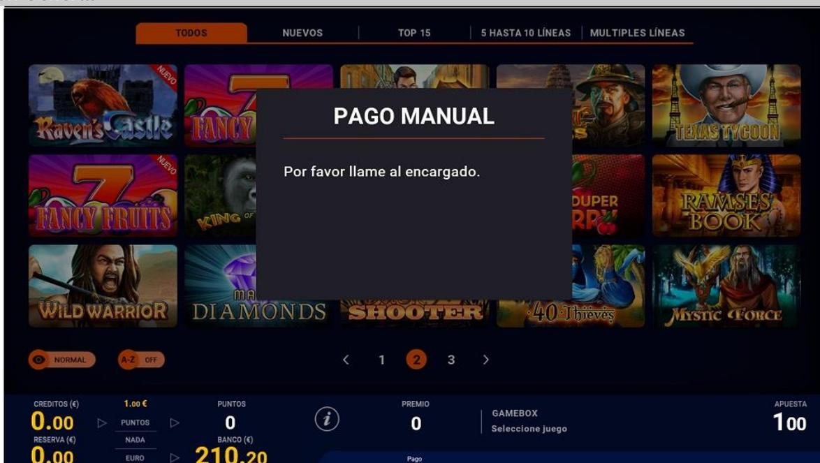
Quando en la pantalla del terminal de juego aparezca el mensaje "Por favor llame al encargado", el encargado de la sala deberá de insertar la tarjeta BAR en el lector de tarjetas del terminal de juego.
