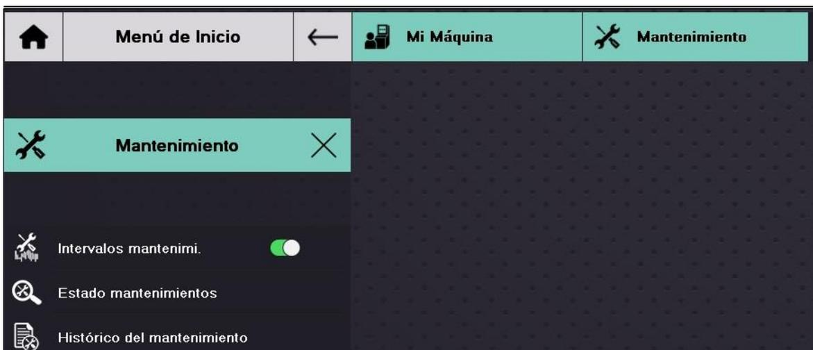
El dispositivo tiene una función de recordatorio para cada tarea de mantenimiento. Esta funcionalidad puede ser activada o desactivada accionando sobre la opción Intervalos mantenimi. Cuando está activa, la máquina avisará con 7 días de antelación a la finalización de un periodo de mantenimiento, mostrando el icono de herramienta en el menú de inicio.
